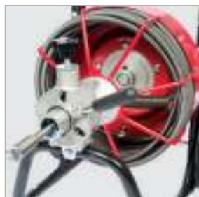
V-Clean с механизмом автоподачи
